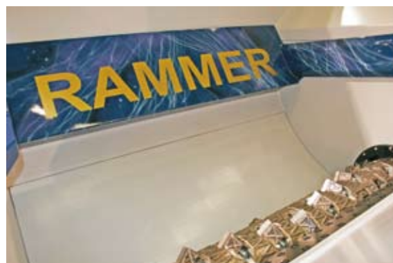
Mit dem innenliegenden Nachdrücker des Typs RAMMER erhält der Shredder 20 Prozent mehr Füllvolumen
